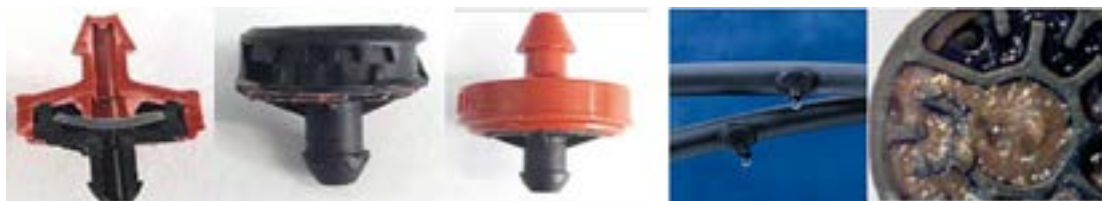
Figura 1: Goteros: (a): tipo “pinchado”; (b): detalle de inserción en la tubería de polietileno y orificio de desagüe y (c) obstrucción de las secciones de paso debido a la formación de “biofilm” desarrollado por la utilización de aguas regeneradas.
